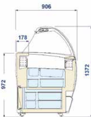
ISABELLA LX - doppelreihige Anordnung der Eisschalen möglich, Tages-Zwischenvorratsfach mit Tür und abgerundeter Griffmulde
