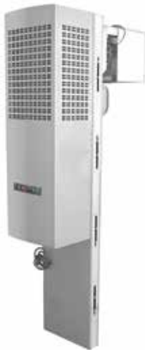
Sonderzubehör: im Wandpaneel steckerfertig vorinstalliertes Kälteaggregat inkl. Feuchtraumleuchte, wodurch der zeitaufwendige Ausschnitt für ein Kälteaggregat entfällt. Servicefreundlich mit automatischer Tauwasserverdunstung und Heißgasabtauung.
