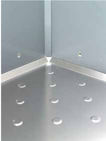
vollhygienischer Edelstahlboden 1.4509 in kreisverpresst, rutschfest genoppter Ausführung, Flächenlast 2000 kg/m 2
